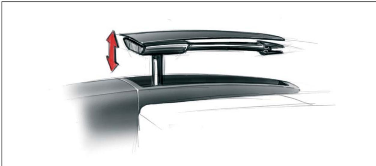
Löschkanone hinter der Steuerkanzel ausfahrbar
